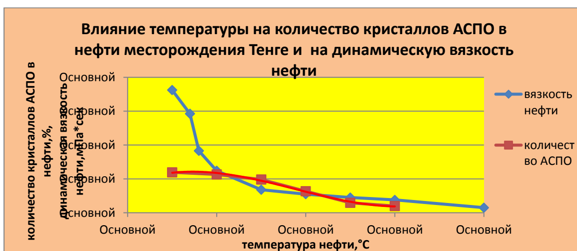
Рис. 2 - График изменения количества осадка АСПО и вязкости нефти в зависимости от температуры
