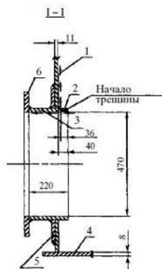
Рис. 4 - Типичная траектория трещины в стенке резервуара (стрелками указано направление распространения трещины) 1-стенка, 2-непровар, 3-патрубок, 4-окрайка, 5-воротник, 6-фланец
